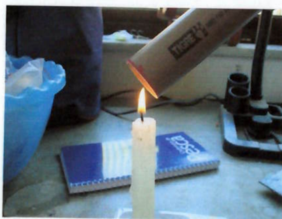
Figura 11.20 - Aquecimento do tubo para ajuste dos anéis
