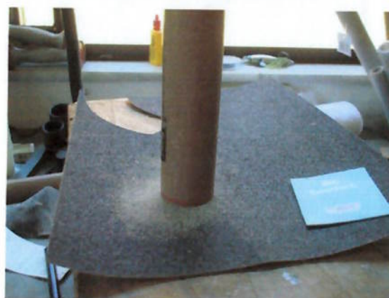
Figura 11.18 - Ajuste da face por abrasão (lixa)
