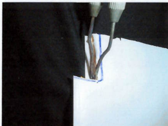
Figura 11.41 - Corte das extremidades das aletas com ferro de solda
