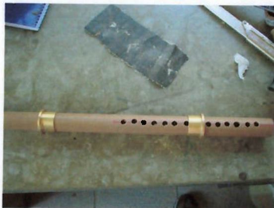
Figura 11.14 - Disposição dos anéis de vedação no tubo do coletor
