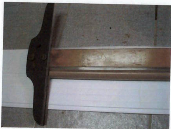
Figura 11.34 - Determinação da linha de centro com régua T
