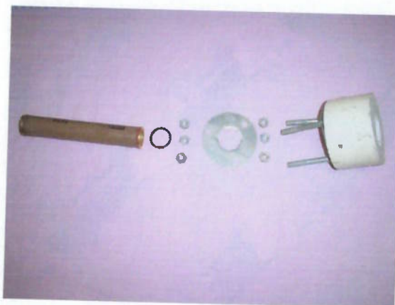
Figura 11.27 - Montagem do flutuador com o seletor
