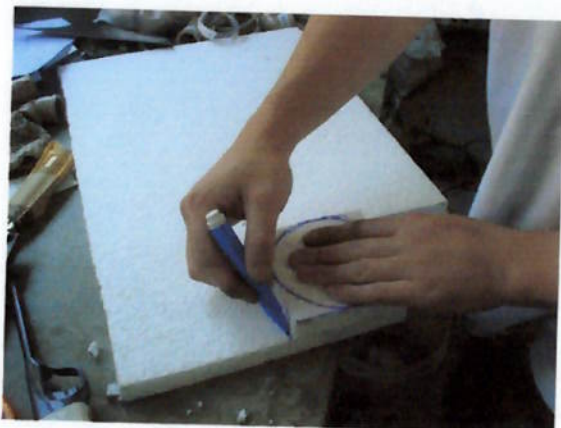
Figura 11.26 - Traçando molde em poliestireno expandido
