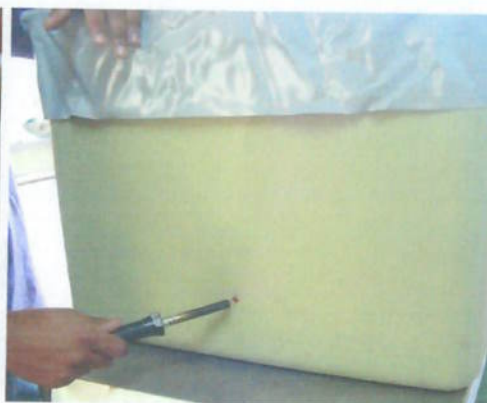
Foto 14: Furo da caixa de isopor com ferro de solda
