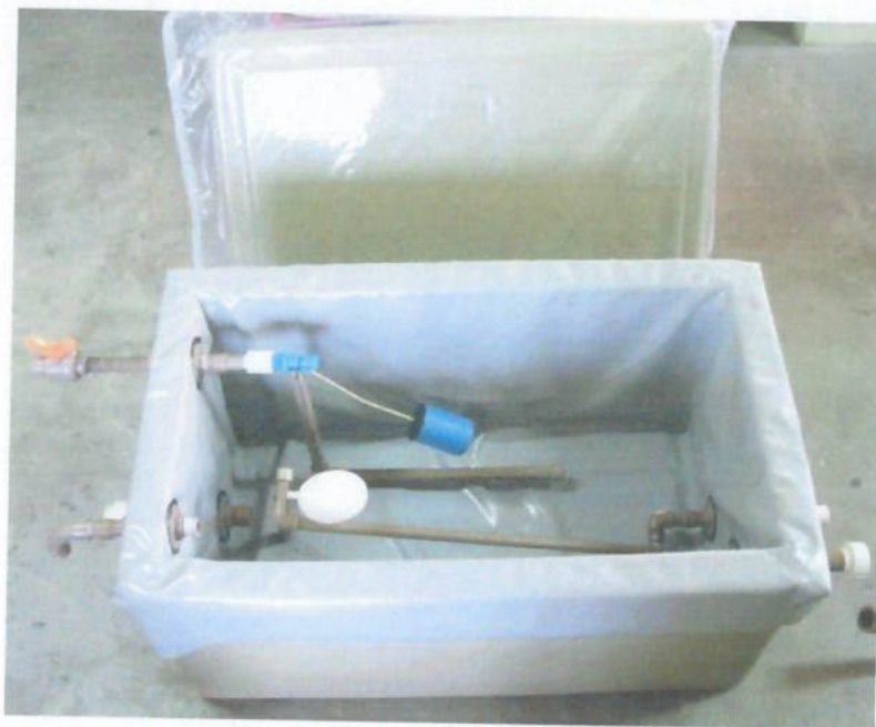
Foto 15: Caixa de isopor 180 litros com todas adaptações para uma caixa de água quente
