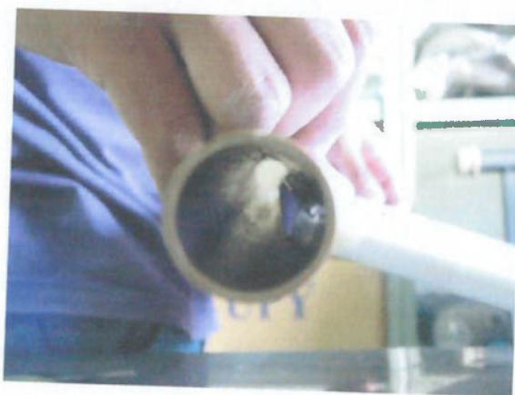
Foto 08: Introdução de 5mm do forro no tubo
