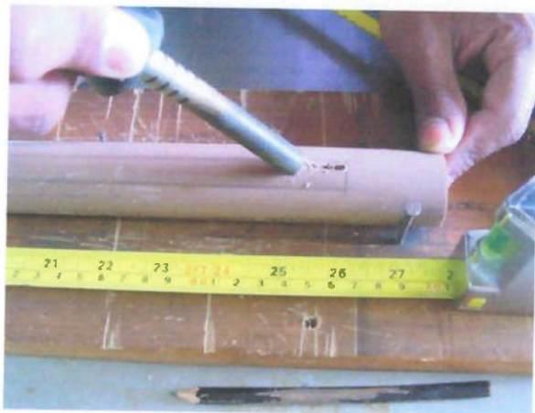
Foto 3: Furo com ferro de solda para introdução da serra
