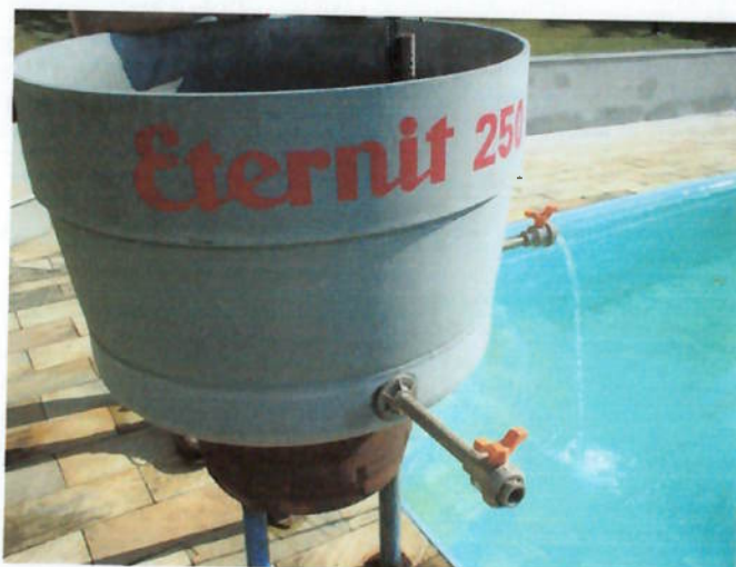
Figura 9.5 - Reservatório térmico de 250 l de concreto (teste hidrostático)
