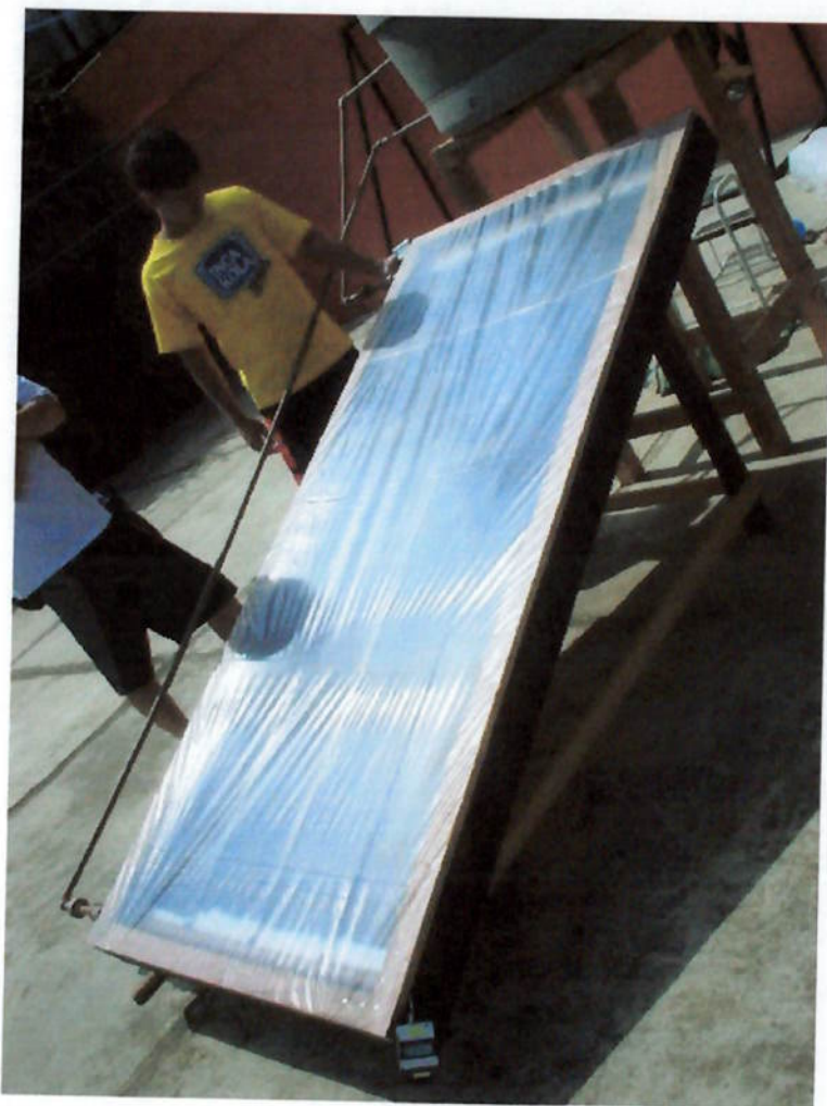
Figura 9.2 - Recipiente anti-convectivo (com plástico transparente de 0,4 mm)
