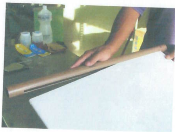
Foto 07: Encaixe do forro no tubo
